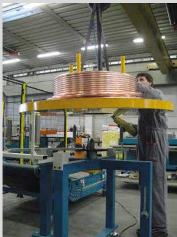
Aspo con piatti rimovibili /decoiler with removable supports
